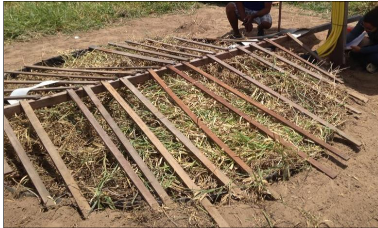
Figura 3. Perfil Instantâneo em Argissolo Amarelo Distrocoeso sob pastagem, localizado em Tabuleiro Costeiro de Cruz das Almas, BA, após o processo de saturação, já com uma cobertura de lona, na superfície do solo, e de palha. Para aumentar a proteção contra a entrada de água, nova cobertura com lona será colocada sobre as ripas.
