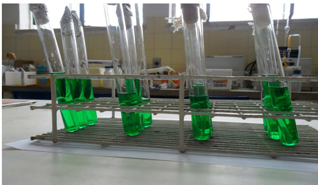
Figura 4: Resultado do Número Mais Provável (NMP) de coliformes totais no queijo petit suisse com adição de probiótico.
