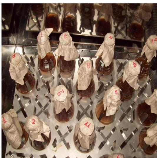
**Figura 1-** Fermentação submersa utilizando erlenmeyers de 250 mL em agitador orbital.
