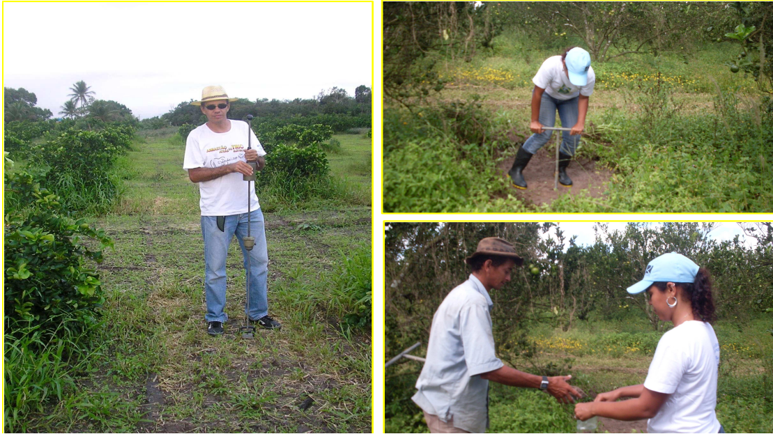
Figura 7 - Determinação da resistência mecânica do solo à penetração e da umidade gravimétrica atual (fotos: arquivo da Universidade Federal do Recôncavo Baiano - UFRB).
