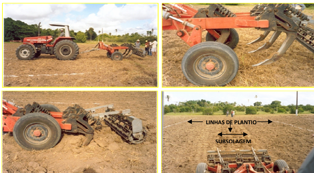
Figura 4 - Instalação do experimento e preparo do solo, com destaque para a subsolagem sobre as linhas de plantio, marcadas com cal. A haste central traseira do subsolador passa sobre a linha de plantio (fotos: arquivo da Universidade Federal do Recôncavo Baiano - UFRB).
