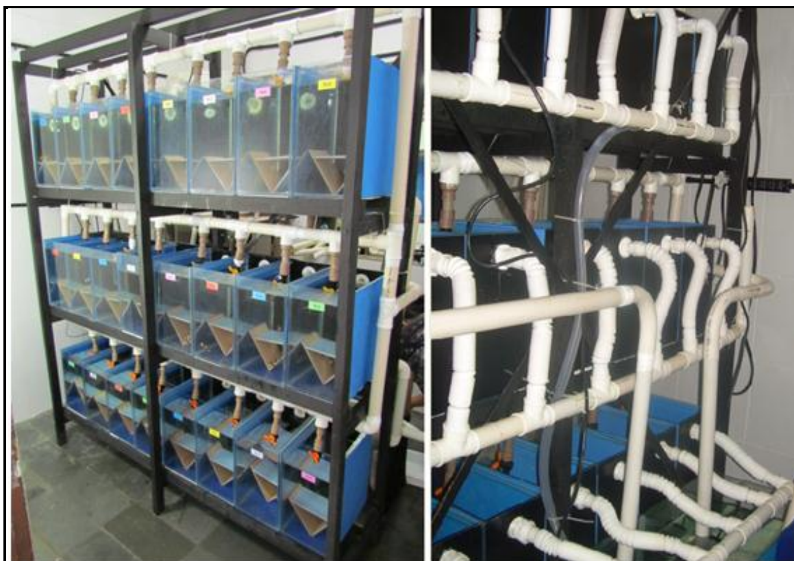
Figura 1. Bateria de aquários onde foi realizado o cultivo do peixe palhaço. Da esquerda para direita: a frente; a parte de trás mostrando a saídas individuais de cada aquário
