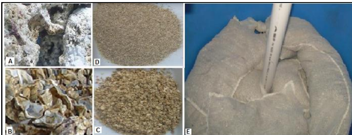
Figura 5. Meio de preenchimento do biofiltro em ordem de sobreposição do fundo para a superfície. A – Pedras calcárias; B – Casca de ostras; C – Casca de ostra triturada; D – Halimeda ; C - Cascas de ostra e Halimeda embaladas em bolsas de tela.
