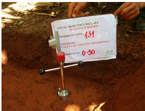
Figura 4 – Coleta de amostra de solo indeformada.
