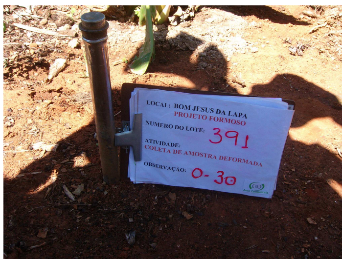
Figura 4 – Coleta de amostra de solo deformada.
