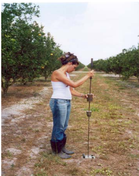
Figura 5 - Penetrômetro de impacto utilizado no ensaio.
