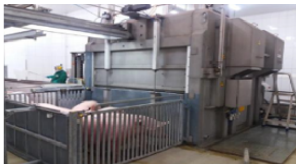
Figura 10. Insensibilizador de suínos com dióxido de carbono (CO 2 )
