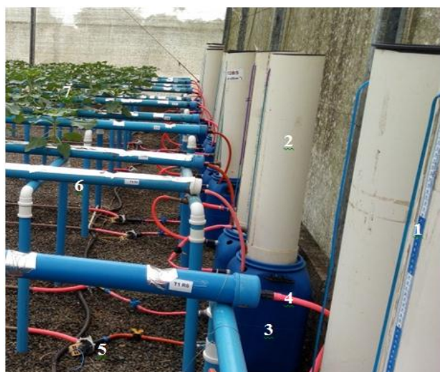
Figura 7. Sistema de abastecimento contendo solução nutritiva acoplado ao perfil hidropônico do Experimento I (Bancada).
