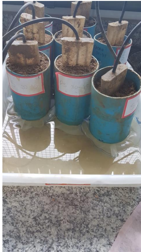
Figura 4. Amostras de solo no momento da saturação por água com as sondas TDR inseridas.
