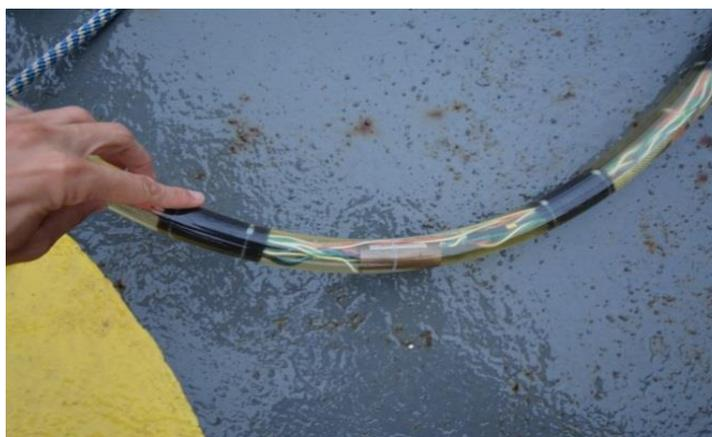
Figura 6. Cabo de reboque com os hidrofones, utilizados para a obtenção dos dados acústicos do PMC. Fonte: PETROBRAS, 2015.
