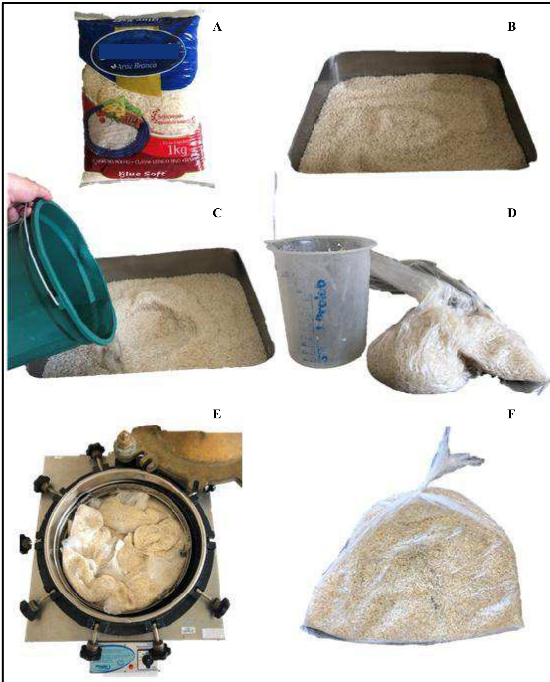
Figura 4– A: Arroz tipo 1 utilizado na culinária; B: Arroz em um recipiente para seu pré-cozimento; C: Adição de água à 100 °C; D: Fracionamento em embalagens plásticas, contendo em cada 0,5 kg; E: Autoclavagem do arroz à temperatura de 121 °C e pressão de 1atm por 20 minutos; F: Embalagem após a esterilização em autoclave.
