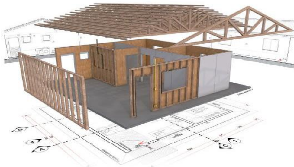
Figura 2: Estrutura da casa em Wood Frame
