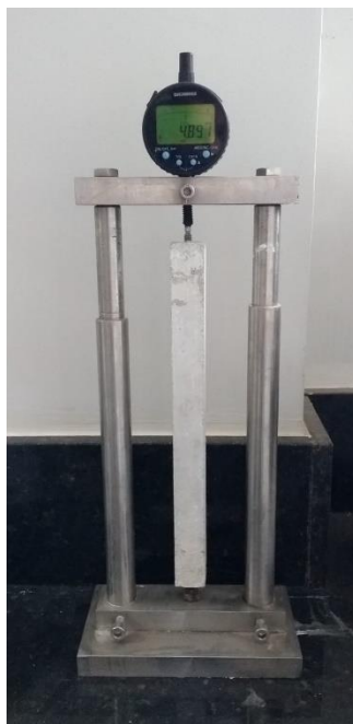
Figura 9: Leitura das barras com o relógio comparador.
