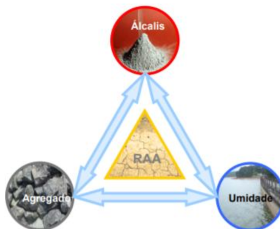
Figura 2: Agentes fundamentais para ocorrência da RAA.
