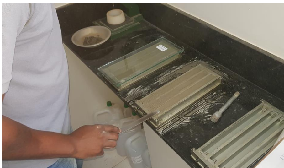
Figura 8: Processo de moldagem dos corpos de prova constituídas com agregados retirados dos testemunhos de concreto.
