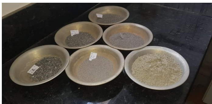
Figura 7: Faixas granulométricas da amostra do agregado graúdo.
