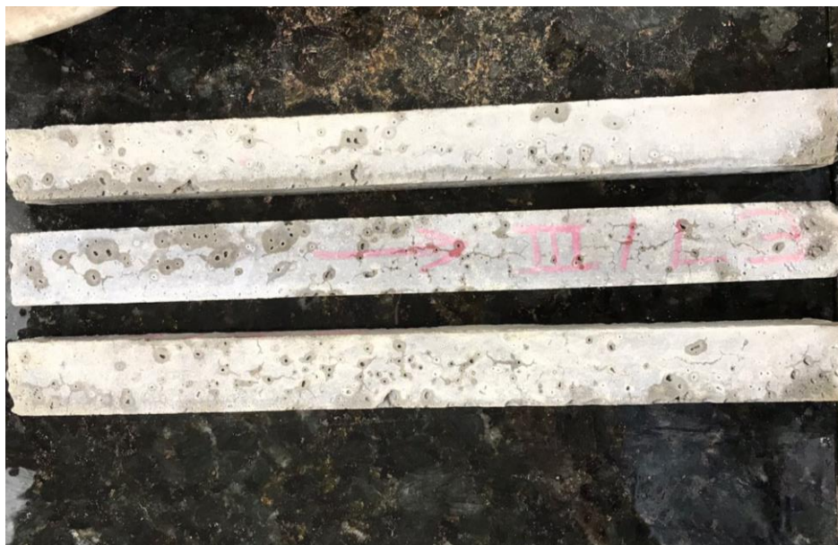
Figura 13: Barras moldadas com agregado graúdo fissuradas.
