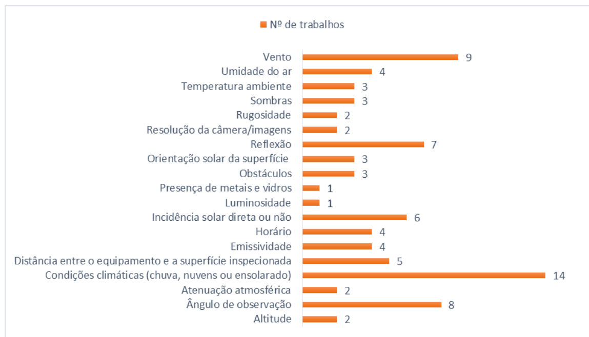
Figura 7: Fatores considerados pelos autores como relevantes em inspeções utilizando sensores termais acoplados à veículos aéreos não-tripulados em inspeções prediais
