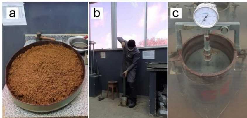
Figura 2 – Mistura e umedecimento da amostra (a); compactação do corpo de prova (b); imersão dos corpos de prova (c).
