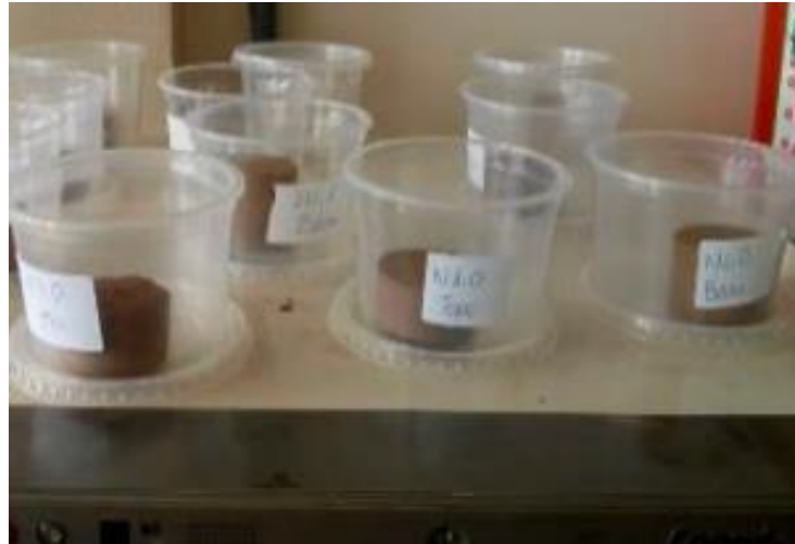
Figura 4: Corpos de prova para o ensaio da curva de retenção (Adaptado de Souza et al. , 2020).
