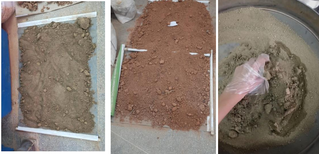
Figura 1: Amostras dos solos estudados: (a) LAD, (b) REG e (c) Umedecimento do VTS.
