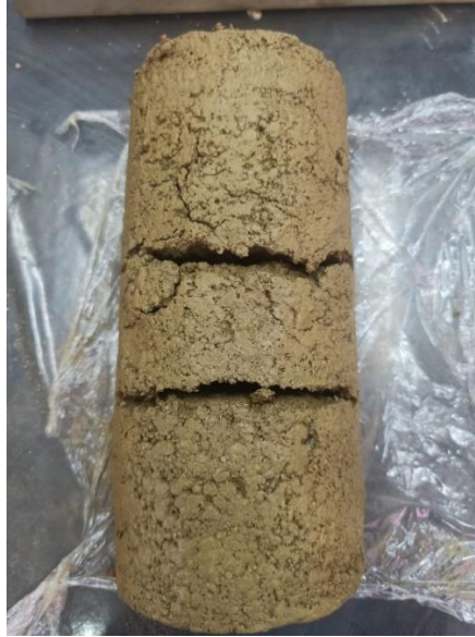
Figura 8: Corpo de prova desagregado na saturação 95%.
