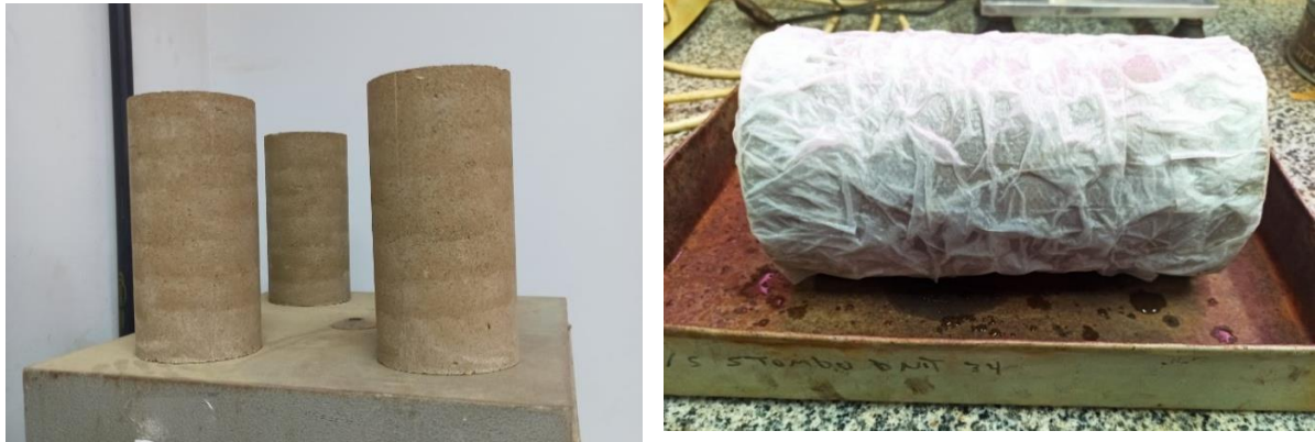
Figura 3: Preparação das amostras com diferentes graus de saturação. (a) Corpos de prova na secagem da estufa e (b) Corpo de prova em processo de umedecimento.
