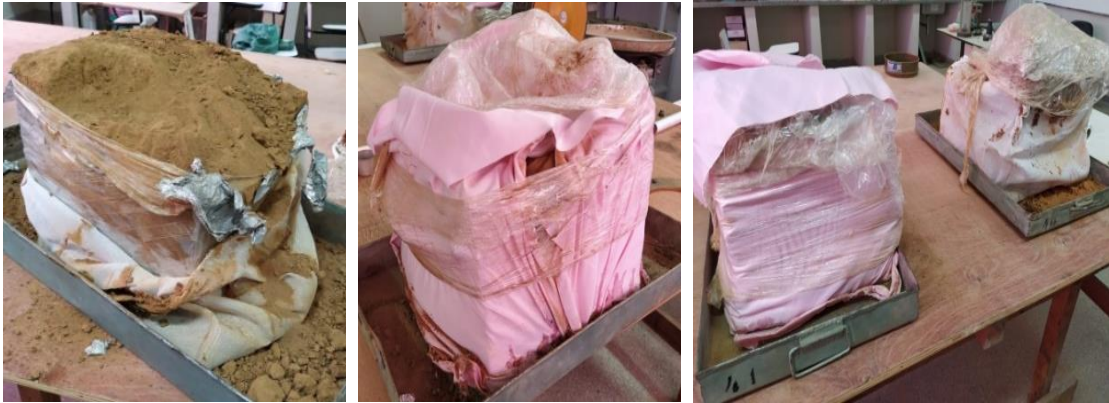
Figura 3.2: Amostras de solo em blocos cúbicos
