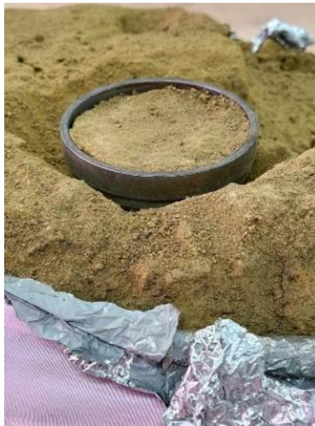
Figura 3.4: Moldagem do corpo de prova
