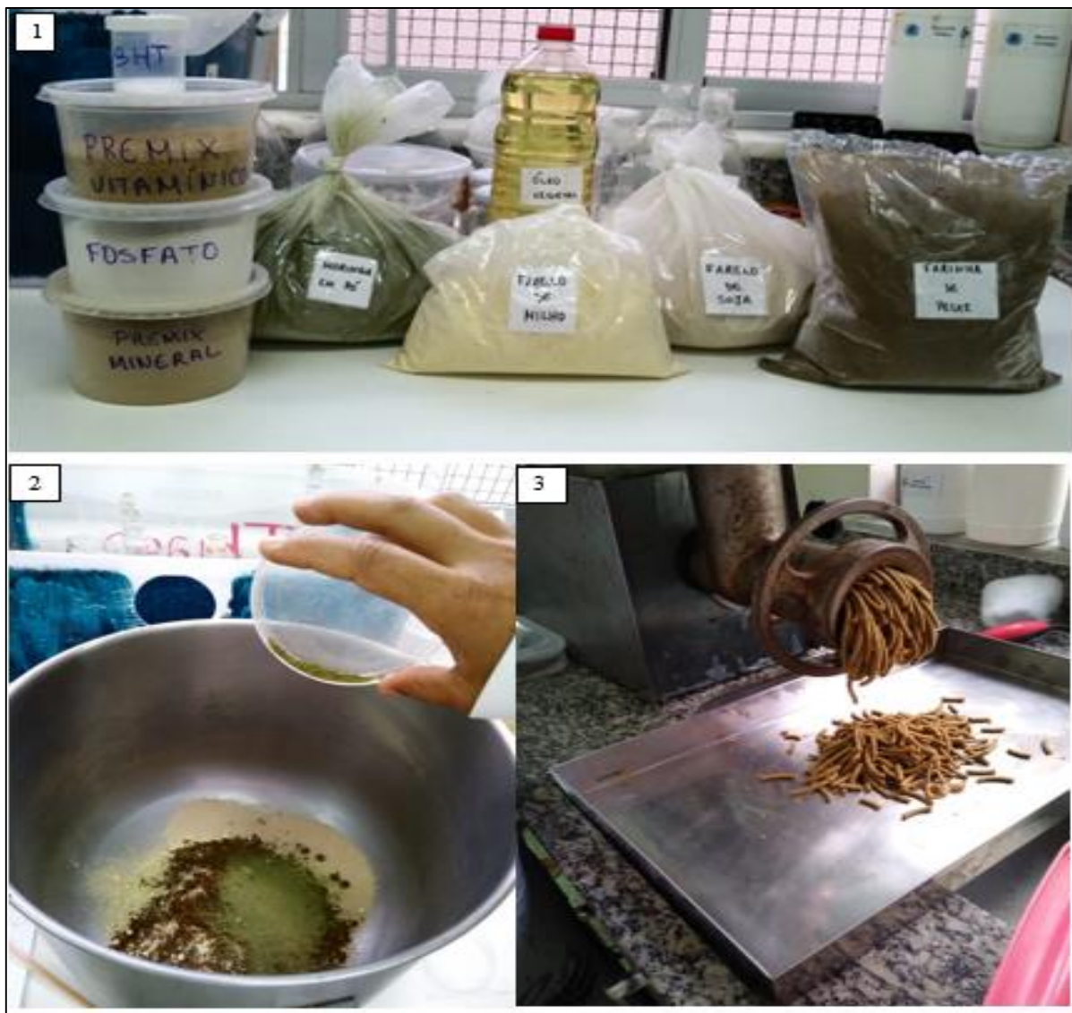
Figura 7. Confeção das rações experimentais; 1 - Separação dos ingredientes; 2 - Mistura dos ingredientes devidamente pesados; 3 - Peletização da ração.
