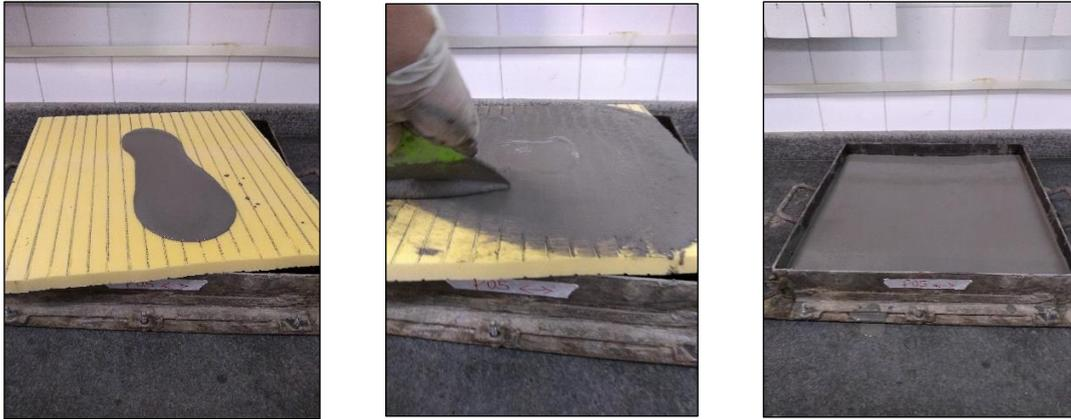
**Figura 17.** Processo de moldagem dos compósitos.
