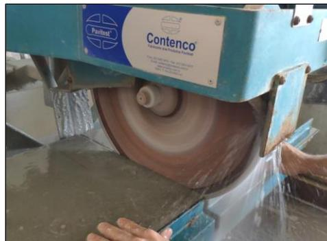
**Figura 18.** Painéis sendo serrados com máquina de polí corte.
