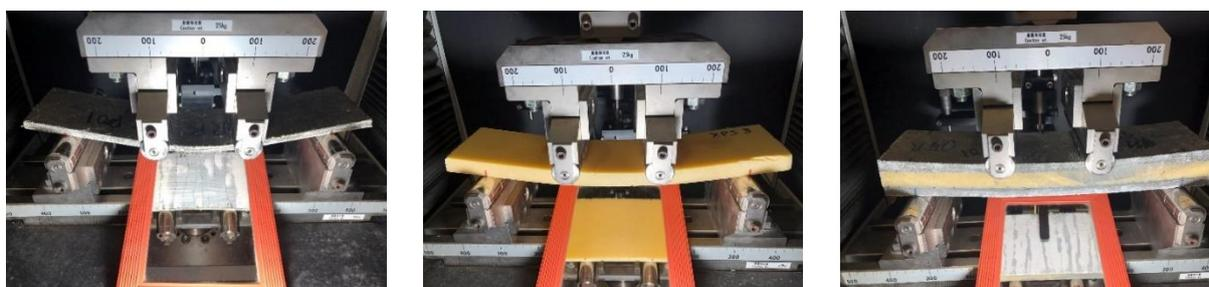
**Figura 21.** Ensaio de flexão em quatro pontos na placa, XPS e painel sanduíche.
