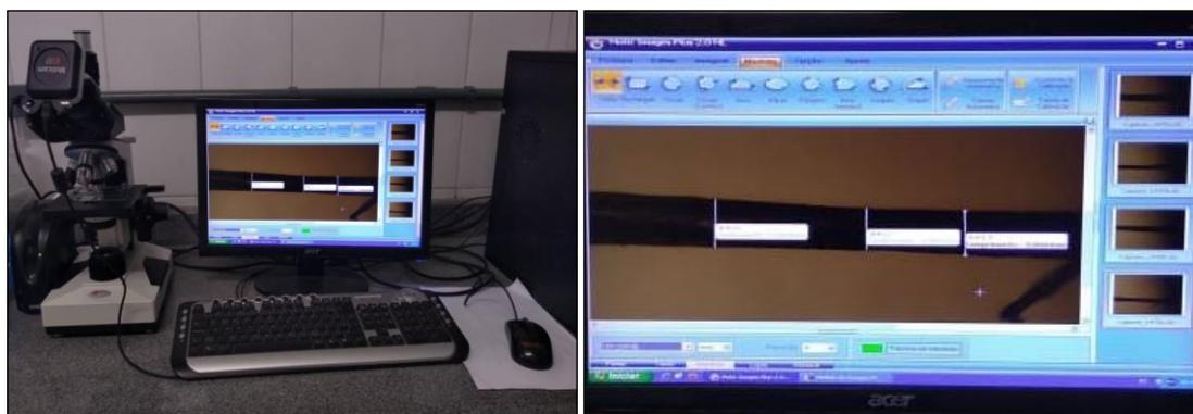
**Figura 9.** Medições das fibras utilizando o software Motic imagens
