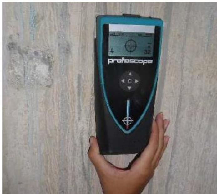
**Figura 4.** Exemplo de aplicação do ensaio de pacometria.
