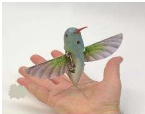
Figura 6 - Modelo de drone: asa batidora.
