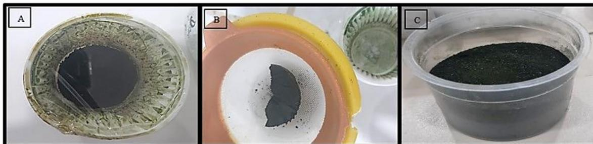
**Figura 14:** A: Pasta após o processo de liofilização; B: Pasta liofilizada sendo peneirada; C: Pasta em pó.
