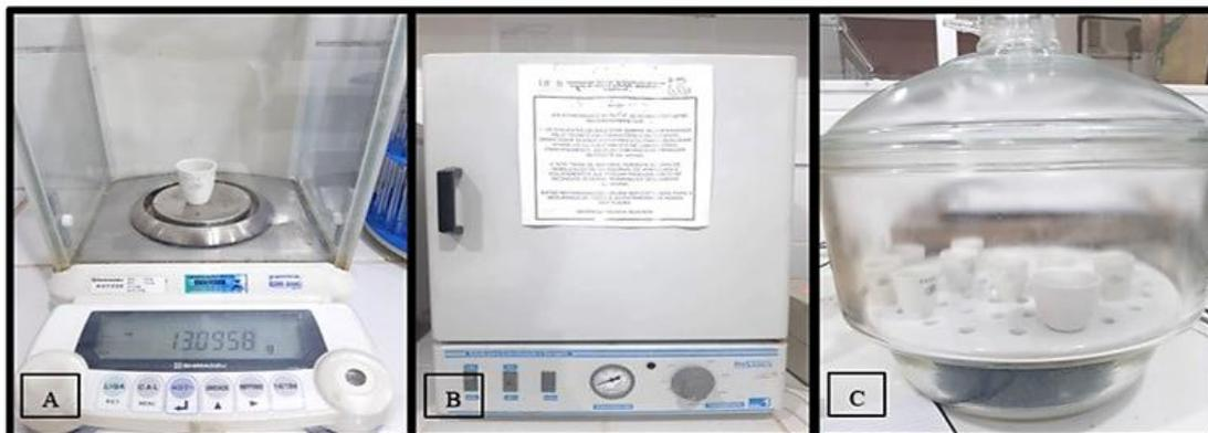
**Figura 9:** A: Balança analítica SHIMADZU- AUY220 de precisão 0,0001g com cadinho contendo a amostra; B: Estufa BRASDONGO MOD.1 para esterilização e secagem; C: Dessecador.
