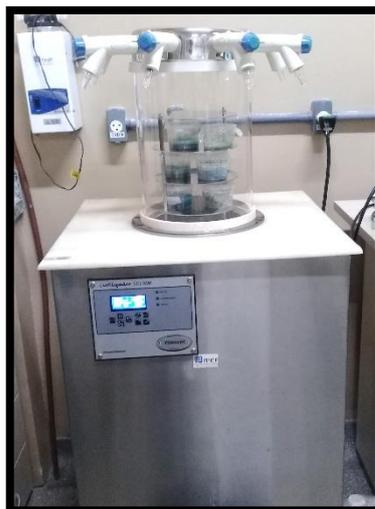
**Figura 6:** Liofilizador TERRONI® série LC 1500.
