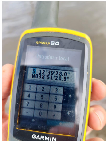
Figura 7. Aparelho de GPS, modelo Garmin GPSMAP 64 utilizado para coleta de dados.
