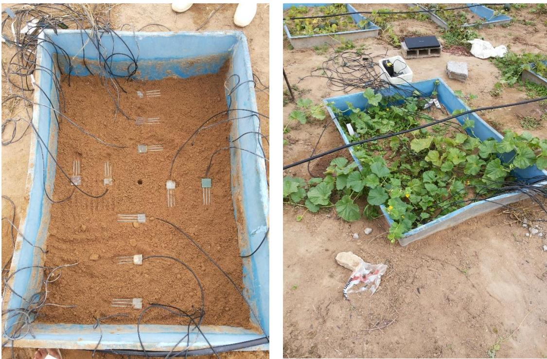
**Figura1-** Lisímetro na fase de instalação de sondas à esquerda e planta do meloeiro na fase de floração à direita.
