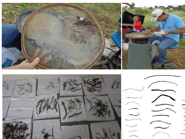
**Figura 5.** Lavagem das amostras das raízes (A); Separação e acondicionamento em sacolas com a solução (B); Secagem natural das raízes (C); Digitalização das amostras (D).
