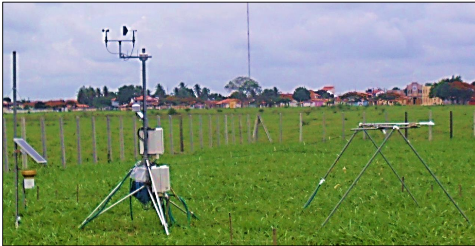
Figura 1. Instrumentação meteorológica de coleta automática de dados instalada na área de capim braquiária, Cruz das Almas, Bahia.
