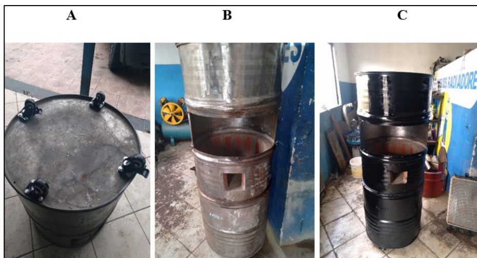
Figura 14 - Etapas de fabricação do defumador: (A) instalação dos rodízios; (B) remoção da pintura antiga (C) processo de pintura com tinta automotiva
