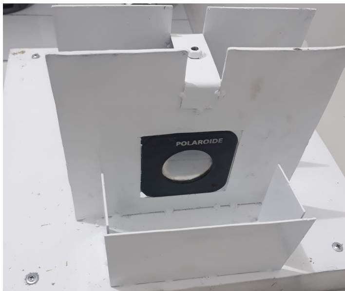
Figura 22: Polariscópio linear feito em chapa metálica
