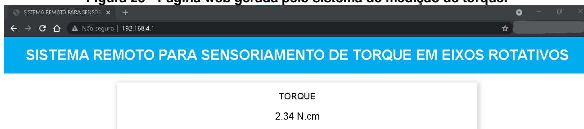
Figura 23 - Página web gerada pelo sistema de medição de torque.
