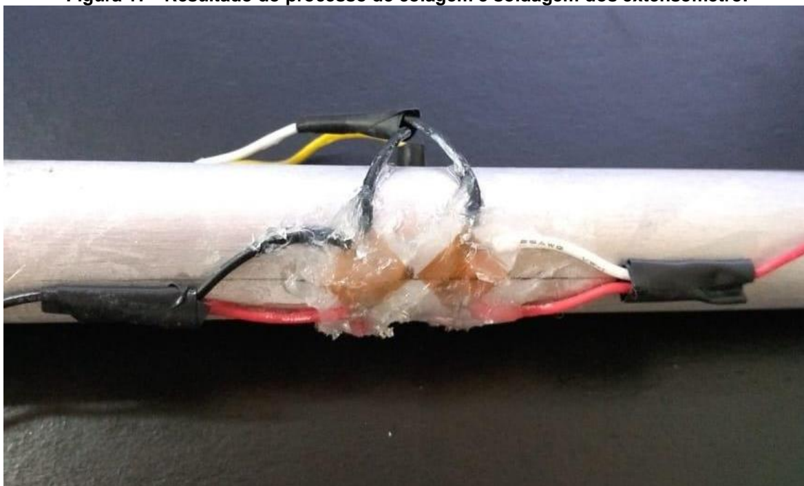
Figura 17 - Resultado do processo de colagem e soldagem dos extensômetro.
