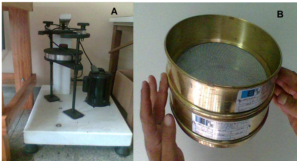
Figura 3: Agitador de peneiras (A) e Peneiras de 20 e 100 mesh acopladas (B).
