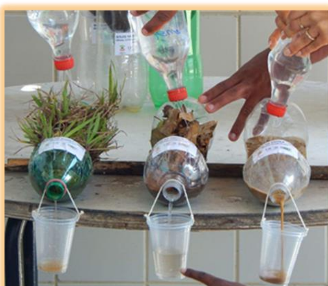
Figura 1 – Calhas utilizadas para simular erosão hídrica.
