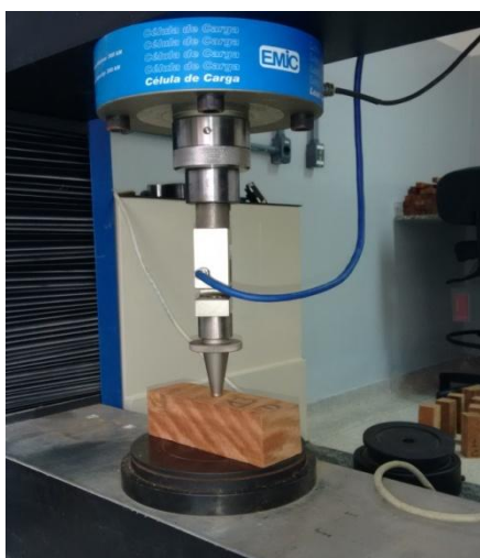
Figura 7: Posição do corpo de prova no momento do teste de dureza Janka.
