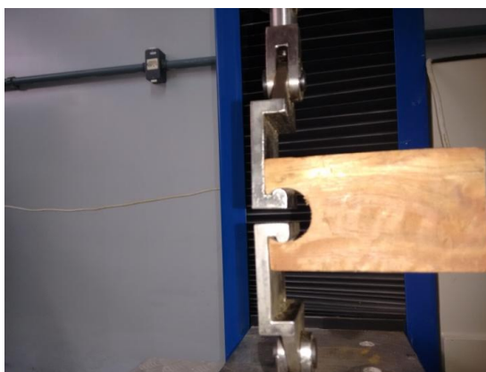
Figura 5: Posição do corpo de prova no momento do teste de fendilhamento.
