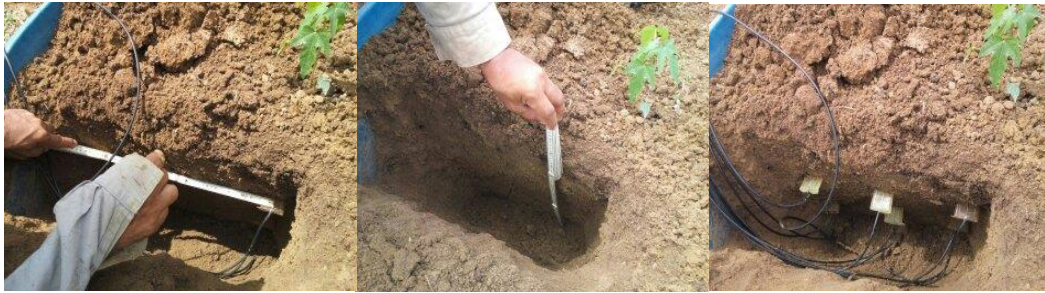
Anexo 3. Instalação dos sensores de umidade do solo nos lisímetros de drenagem.
