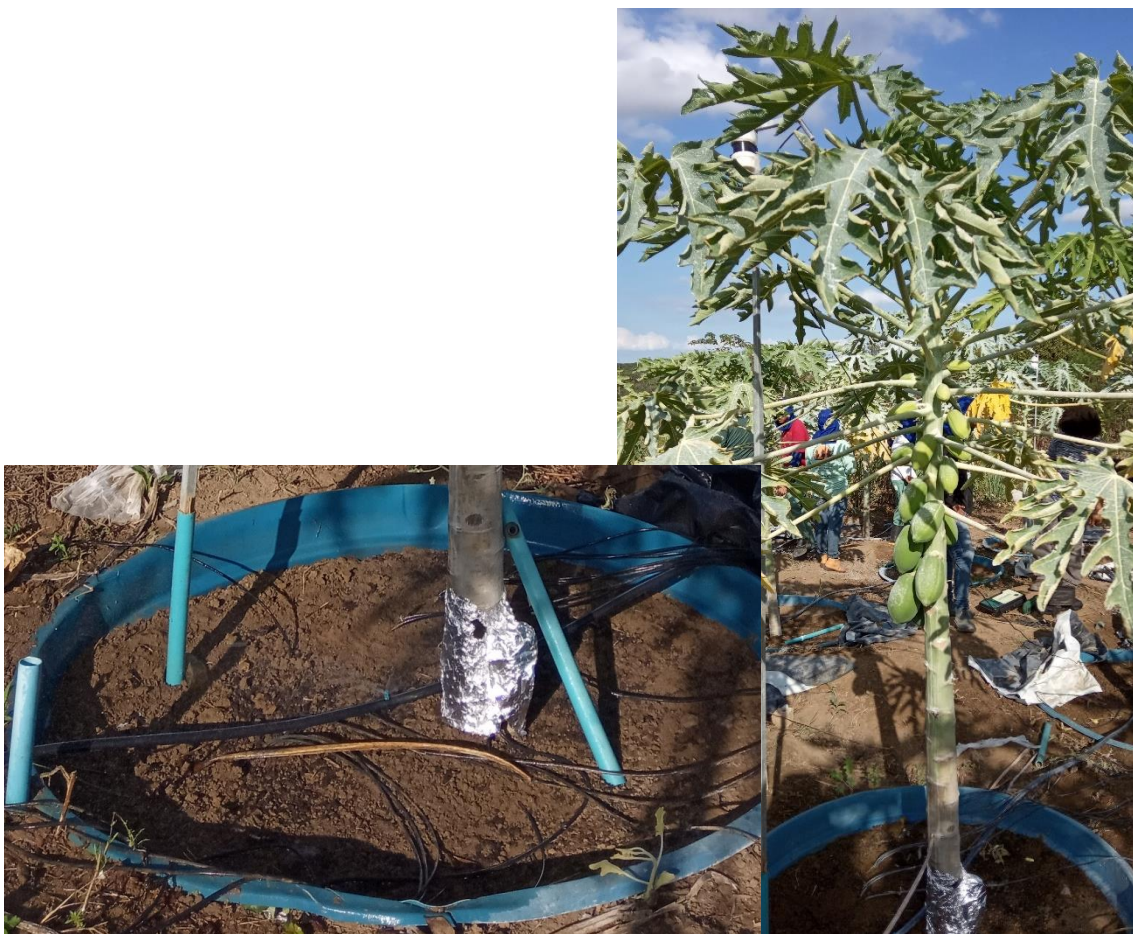
Anexo 4. Sensores de pulso de calor instalados em planta de mamoeiro e protegidos com papel alumínio, para mensuração do fluxo de seiva.
