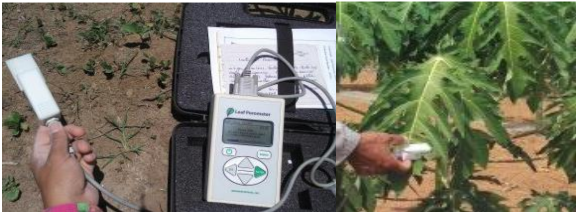
Anexo 2. Porômetro modelo SC-1 (Decagon) utilizado nas medições de condutância estomática nas folhas do mamoeiro, cv. Tainung 1.
