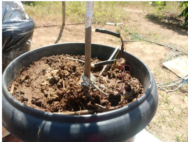
Figura 4. Detalhe da sonda de dissipação térmica, instalada em muda de atemóia. Foto: Santos, I.M.
