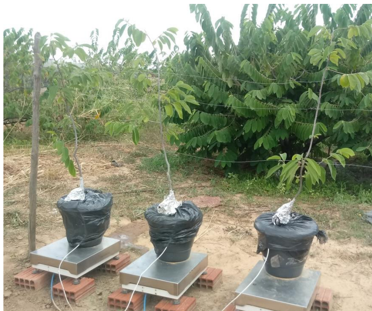
Figura 2. Experimento de calibração da sonda de dissipação térmica para a atemóia. Juazeiro-BA.
