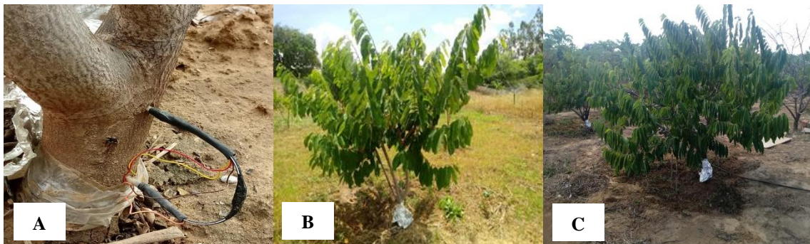
Figura 14. Detalhe das sondas instaladas (A); Monitoramento do fluxo de seiva da atemóia em pomar jovem (B) e adulto (C). Juazeiro,BA. Foto: Santos, I.M.
