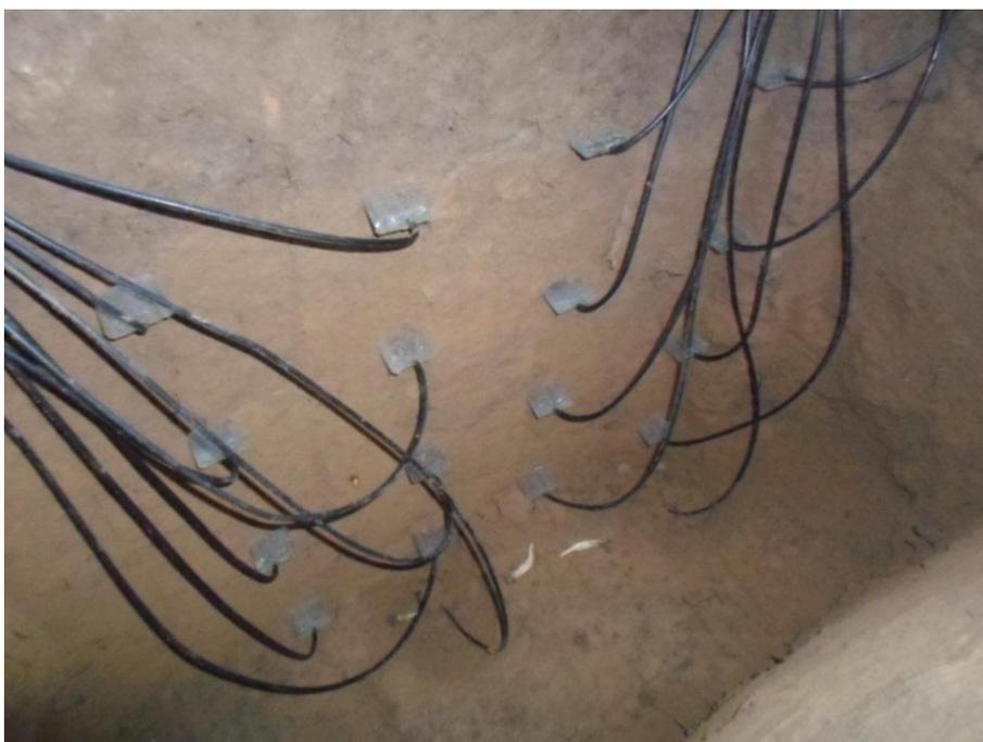
Figura 2. Representação de instalação das sondas TDR nas Trincheiras.
