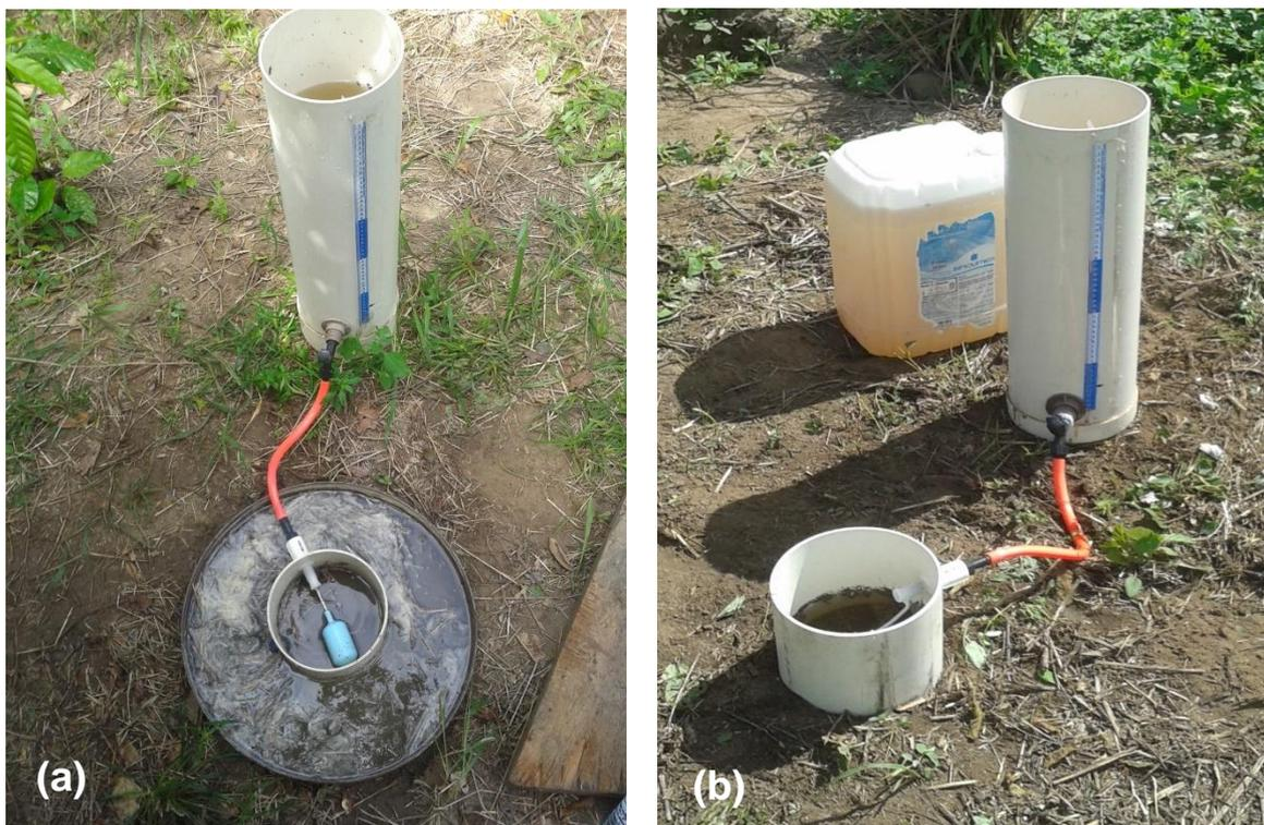
**Figura 1. Infiltrômetros de anéis duplo (a) e simples (b) utilizados para determinação da velocidade de infiltração da água no solo. Cruz das Almas, BA, 2017.**
