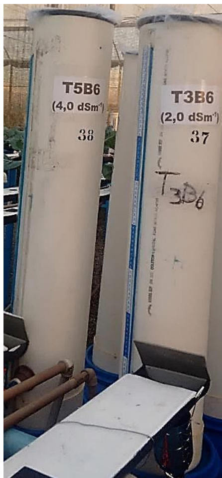
Figura 5. Tanque graduado do sistema de abastecimento automático, instalado na parcela hidropônica para obtenção do consumo hídrico de plantas de couve-folha
