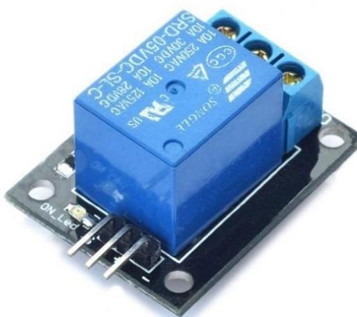
Figura 7 - Módulo relé de 5V
