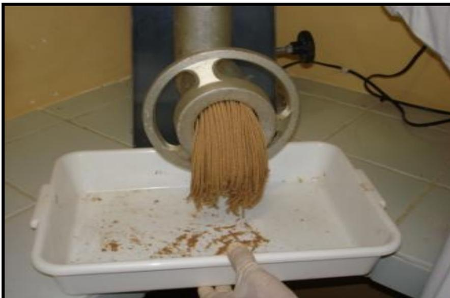
Figura 4: Processo de peletização da ração utilizada no experimento.
