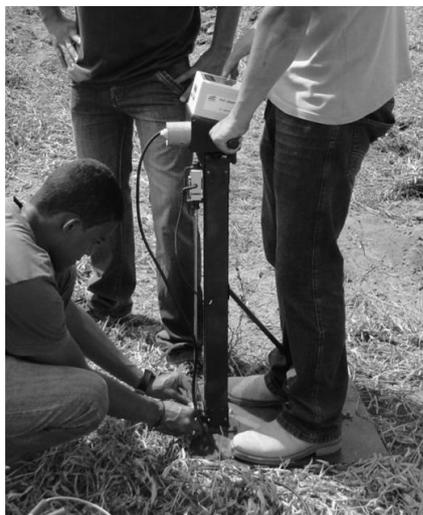
Figura 1 - Medida da resistência à penetração do solo com uso dopenetrômetro DLG, modelo PNT-2000/motor.
