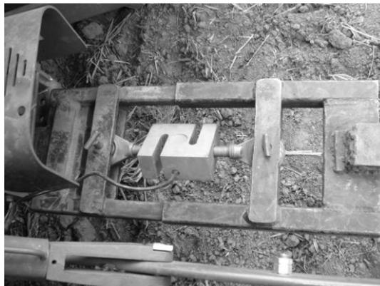
Figura 3- Célula de carga utilizada na medição da força de tração requerida pelos implementos utilizados.
