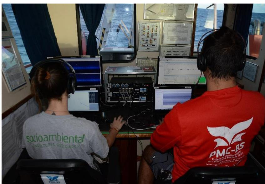
**Figura 7:** Operadores na Estação de Monitoramento Acústico Passivo (MAP), localizada na ponte de comando da embarcação *Sea Route*, durante a Campanha de MAP. Fonte: Petrobras, 2017.
