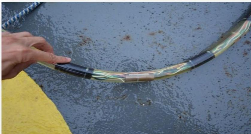
**Figura 6:** Cabo de reboque, com destaque para o hidrofone. Fonte: Petrobras, 2016.
