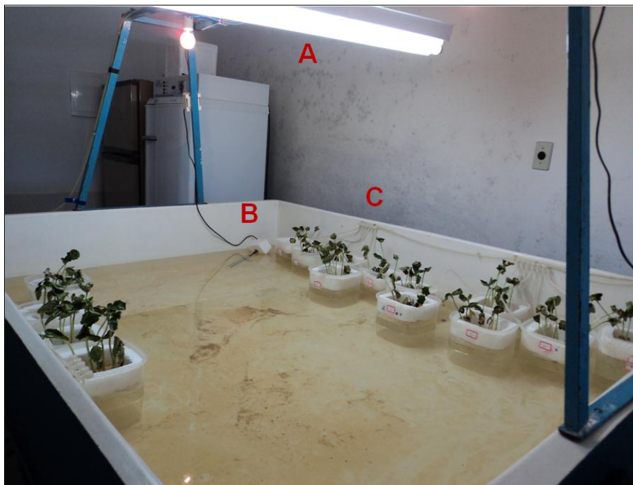
Figura 3 – Tanque de hidropônia indicando em A : o sistema de iluminação permanente, em B : as resistências adaptadas ao tanque mantendo a temperatura da água em 25° e C : o sistema de aeração com tubos ligados aos vasos com as amostras.
