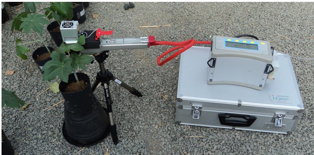
Figura 7 – Sistema de medição de trocas gasosas portátil LC-pro+ (ADC Bioscientific Ltd., England) equipado com uma fonte de luz azul/vermelho.
