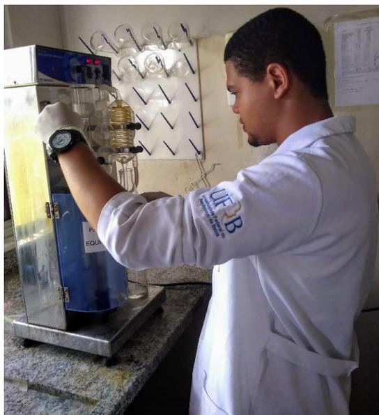
Figura 11. Processo de destilação para determinação da Proteína Bruta
