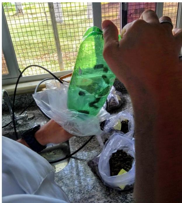
Figura 12. Teste de estabilidade dos péletes (adaptação do método de Holmen)
