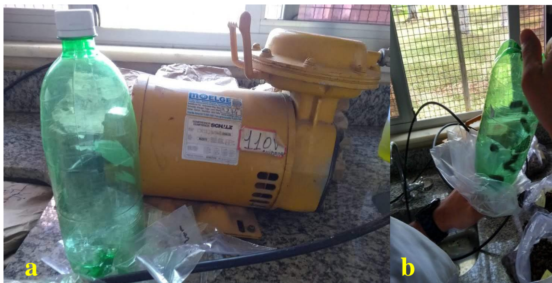
Figura 10: Mensuração do PDI; a) Materiais usados para mensurar o PDI; b) Péletes submetidos aos jatos de ar.
