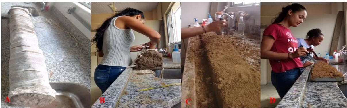
Figura 2: Monólito sendo retiradas as ataduras de gazes (A) e (B). Monólito de solo sendo desbastado para início da limpeza (C). Monólito na altura da forma metálica (D).
