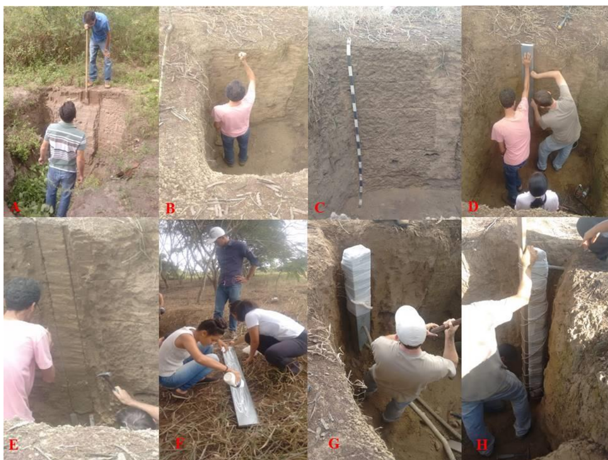
Figura 1: Limpeza da trincheira e da parede do perfil (A) e (B). Sequência dos horizontes (C). Fixação da placa do monólito (D). Marcação do perfil para coleta (E). Aplicação de cola branca na parte interna da forma metálica (F). Escavação do monólito (G). Monólito enrolado com ataduras de gazes (H).
