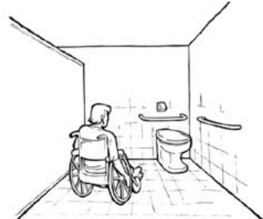
Figura 28- Banheiro possibilitando área de transferência lateral ou diagonal.
