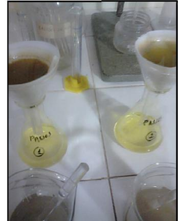
Figura 33: Filtragem da amostra líquida, recolhida em um erlenmeyer.
