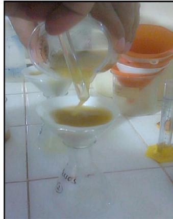
Figura 32: Filtragem da amostra líquida.
