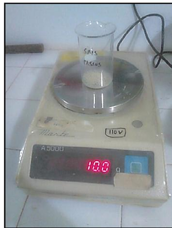
Figura 29: Pesagem da amostra de argamassa moída e seca.
