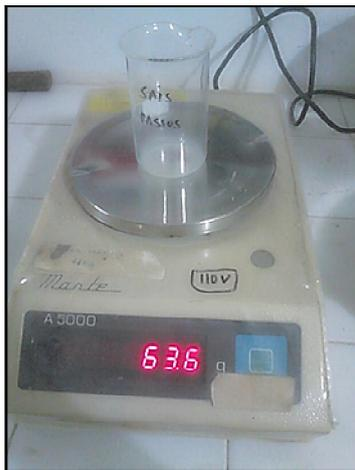
Figura 28: Pesagem do béquer sem amostra.
