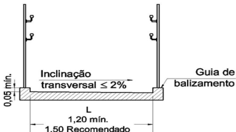
**Figura 20:** Inclinação transversal e largura de rampas – Exemplo
