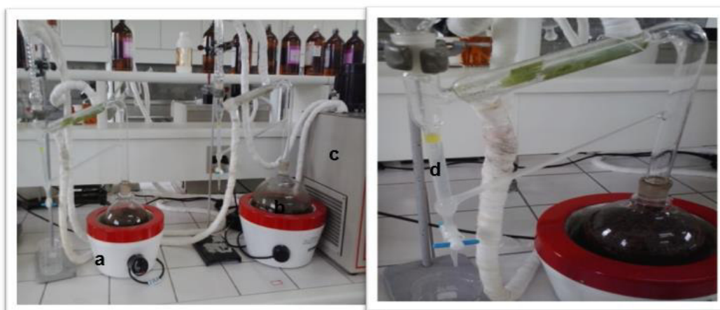
Figura 3. Aparelho Clevenger: (a) Manta aquecedora (b) Balão volumétrico; (c) Refrigerador do sistema; (d) óleo essencial sendo extraído.
