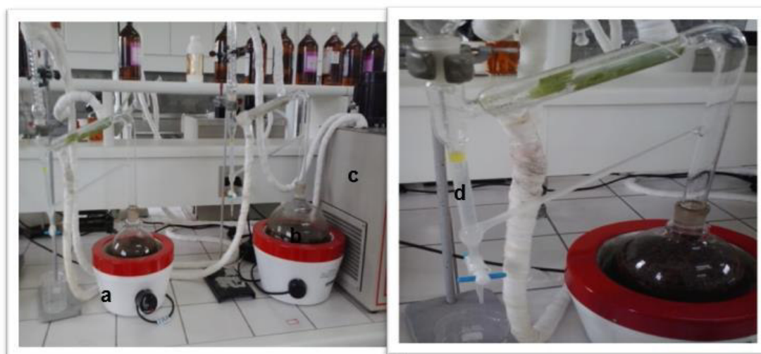
Figura 3. Aparelho Clevenger: ( a ) Manta aquecedora ( b ) Balão volumétrico; ( c ) Refrigerador do sistema; ( d ) óleo essencial sendo extraído.
