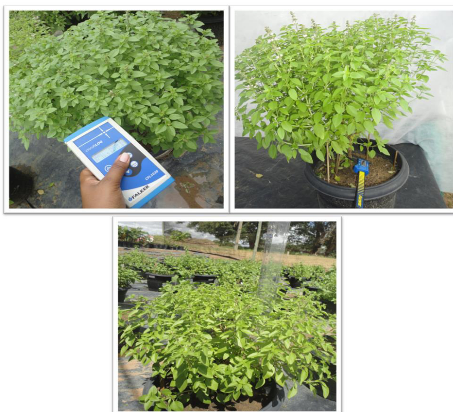
Figura 2. a – Medidas de clorofila a, b e clorofila total, com o aparelho Clorofilog, b - Medidas de diâmetro, com auxílio do paquímetro eletrônico c - medidas de altura utilizando régua graduada.
