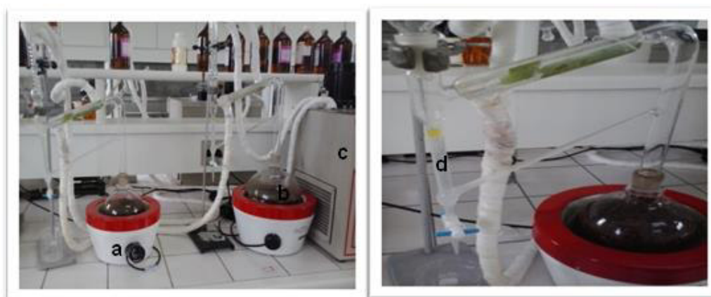
Figura 5. Aparelho Clevenger: ( a ) Manta aquecedora ( b ) Balão volumétrico; ( c ) Refrigerador do sistema; ( d ) óleo essencial sendo extraído.
